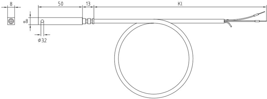
Kleines Anlegewiderstandsthermometer im Aluminiumgehäuse (Kabelfühler). Der Oberflächenfühler **THERMASGARD® OUTF** dient zur Temperaturerfassung auf geraden und leicht gewölbten Oberflächen, z.B. zur Oberflächen-temperaturmessung an Fenstern, zur Überwachung der Kondensatbildung oder als Heizflächenfühler z.B. an Fenstern oder Wänden.
