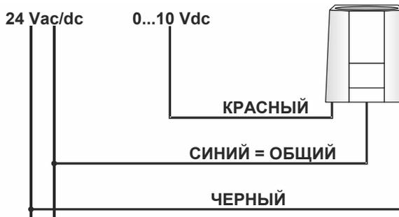
Рис. 7. Схема подключения
