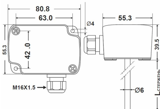
Рис. 1. Габаритные размеры датчика температуры в мм
