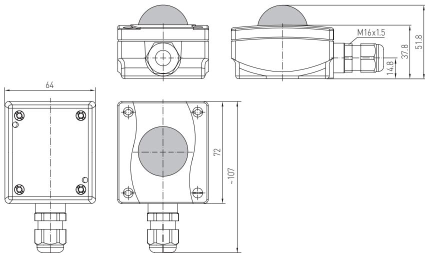
Widerstandsthermometer **THERMASGARD® ASTF** mit passivem Ausgang, mit Klemmkastengehäuse aus schlagzähem Kunststoff, Gehäusedeckel mit Schnellverschlusschrauben.
